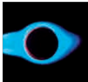
Magas lángmérséklet a csavart lángterelésnek köszönhetően
