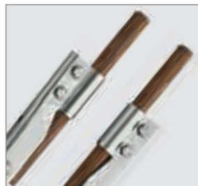
Rúdelektrodák a falközeli vagy párhuzamosan egymás mellett vezetett csövek forrasztásához (nem tartalma a készletnek)
